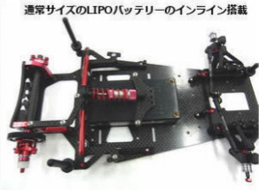
通常サイズのLiPoバッテリーのインライン搭載
